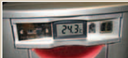
Панель с регуляром скорости вращения вентилятора и термометром в корпусах Thermaltake Xaser II
